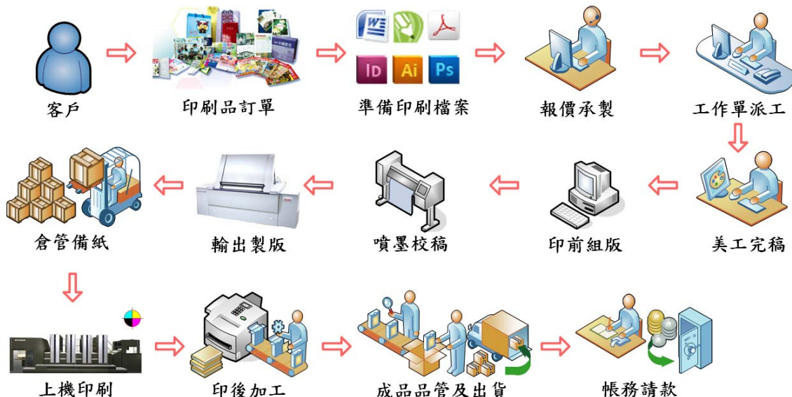
圖 3. 個案的紙類印刷品生產工作流程
