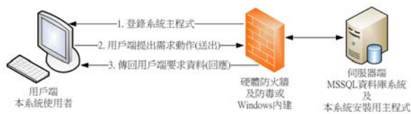
圖 8. 系統執行操作方式示意圖
