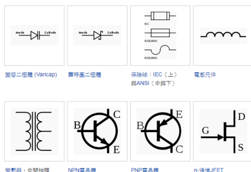
圖 5.常見的電子元件符號
