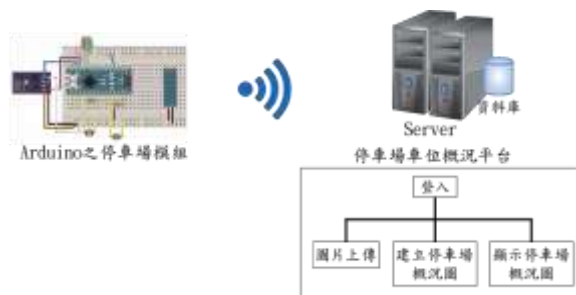
圖 9 Server 端停車場車位儲存暨顯示系統架構圖
