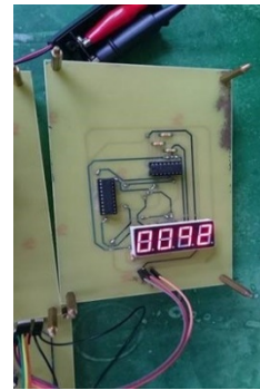
圖 24 七段顯示器顯示即時心率為 92
