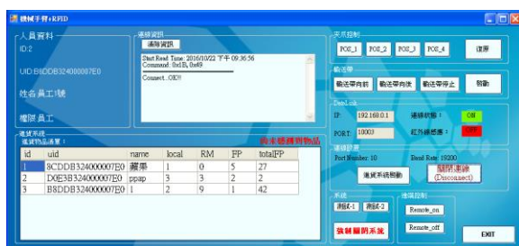
圖 14、手臂主控系統連線和抓取資料庫資訊
