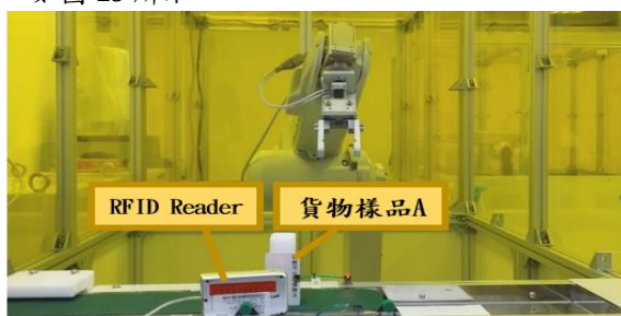
圖 28、物體經過 RFID 感測點進行讀取判斷
