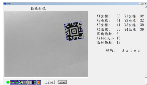
圖 3.2-5 視窗程式介面圖(方位校正)
