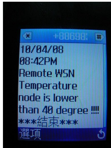
圖 10 WSN 監控平台所發送出的緊急簡訊通報功能
