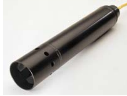
圖 4 濁度計設備 WQ710
