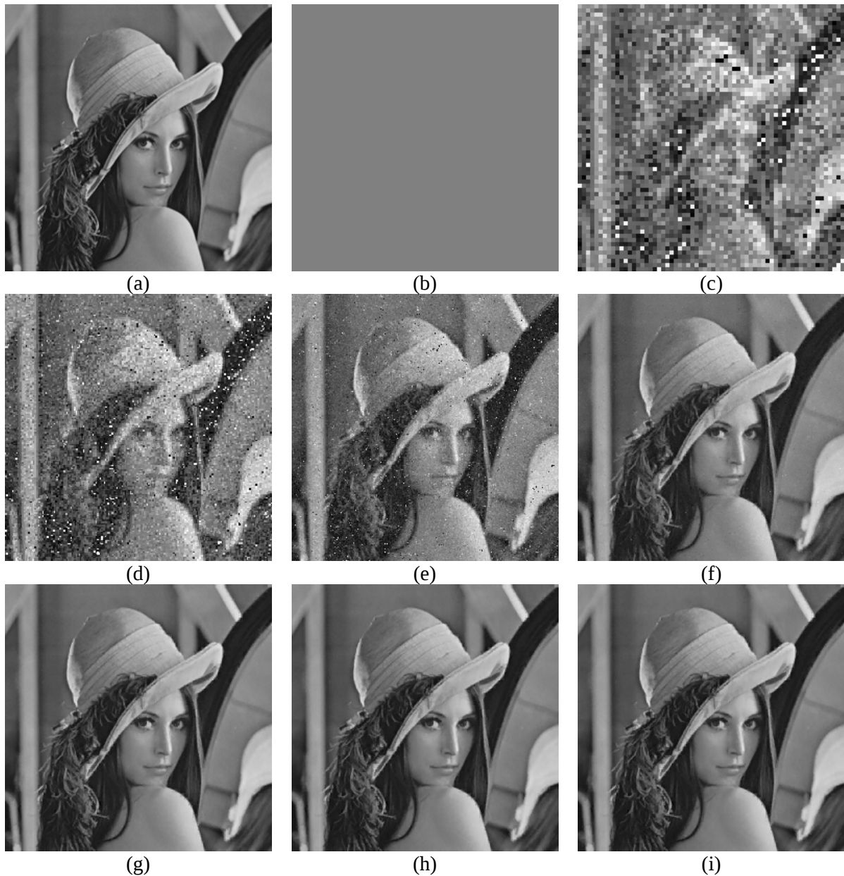
圖五、256×256 大小的影像解壓縮疊代過程：(a)原始影像，(b)初始影像，(c)疊代 1 次 (PSNR=15.10)，(d)疊代 2 次 (PSNR=17.42)，(e)疊代 3 次 (PSNR=21.75)，(f)疊代 5 次 (PSNR=30.96)，(g)疊代 7 次 (PSNR=33.63)，(h)疊代 12 次 (PSNR=34.51)，(i)疊代 20 次 (PSNR=34.56)
