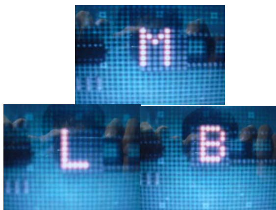
圖 4.2 由核心 2 所控制點矩陣 LED
