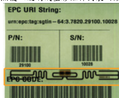
圖表 1 附有條碼的 RFID 標籤嵌有矽晶片以及感測用的天線
