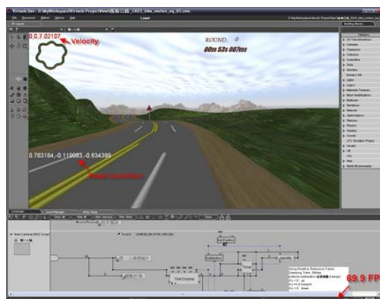
圖 23 地形回饋和自行車動態方程式測試與 Vitools FPS 執行效率
